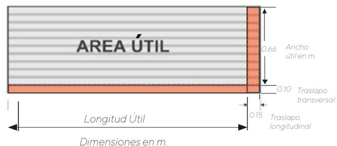
**Nota:** Siempre realice la perforación de las tejas en la cresta y no en el valle, utilice broca con un diámetro mayor al del elemento de fijación (1/8" mayor). Nunca perforo con puntilla.
